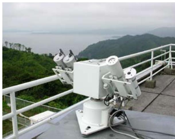
*Fotómetro solar para caracterizar aerosoles en la estación de la VAG de Ryori (Japón), que mide la cantidad total de aerosoles atmosféricos.*
