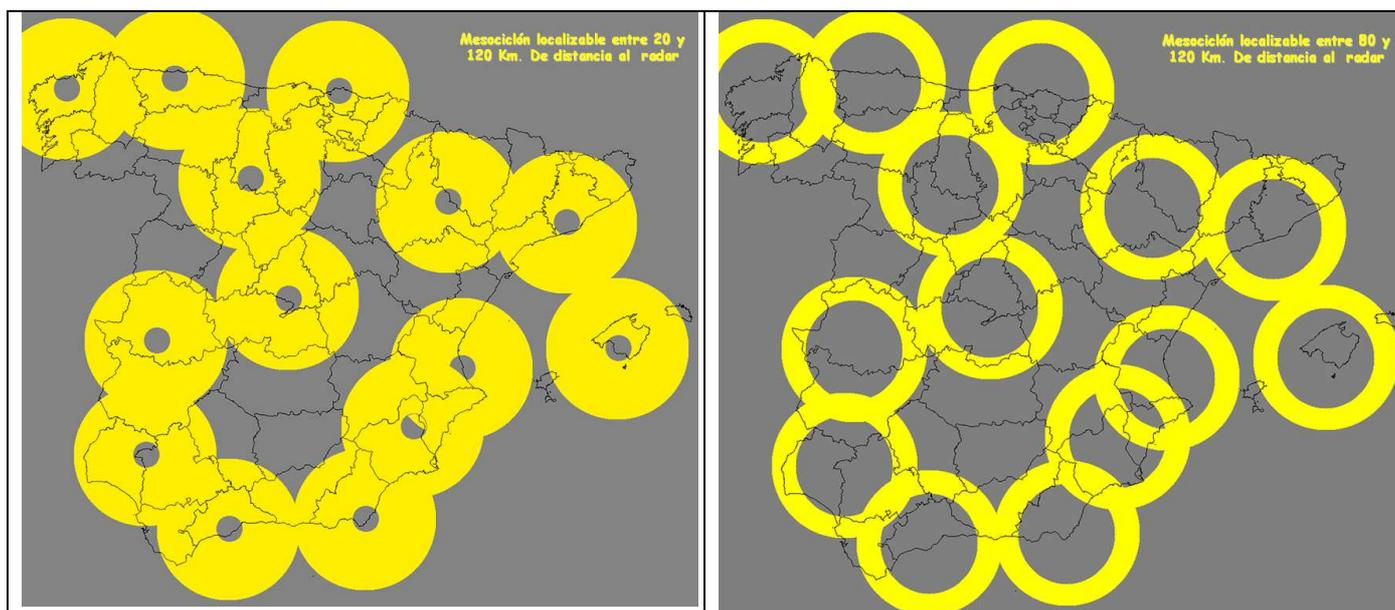
Figura 3.37. Cobertura real para detectar un mesociclón en capas bajas (izda.), o en capas medias (dcha.).
