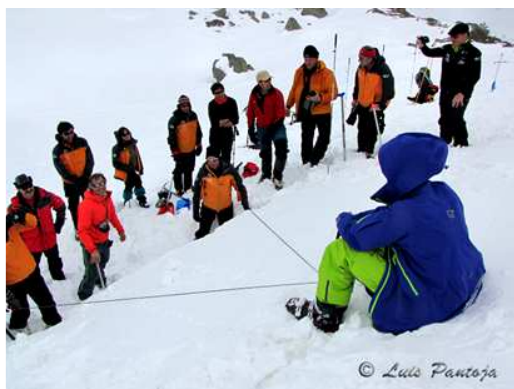
Fig. 79 Corte para el test de cuña deslizante
