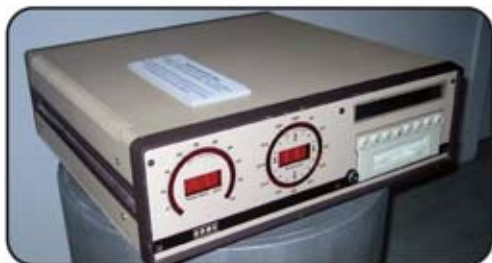
Estación meteorológica automática
